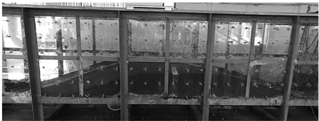
图 5 模型土体填筑效果图 Fig. 5 Effect diagram of model soil filling
