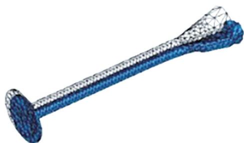
图 14 连接件破坏状态模拟图
