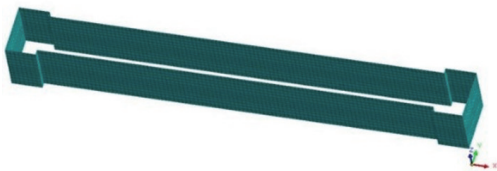
(b) 三轴搅拌桩止水帷幕模型示意图
